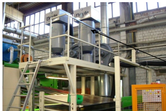
Fan and Filter unit 2 x 7,5 KW
