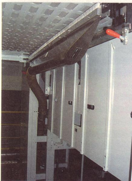
fenlos regulierbaren Vakuums, der Bogen abgesaugt und gereinigt wird. Über Gewebefilter wird die Luft gereinigt und der Staub mittels eines Zyklons in einen Behälter transportiert. Durch eine manuelle oder automatische Wegschwenkvorrichtung wird der Absaugkopf auf die vorher
